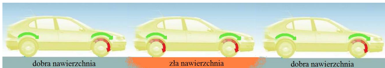
Rys. 3. Działanie sterownika przy zmiennych warunkach przyczepności strzałka zielona – kierunek obrotu koła, strzałka czerwona – koło napędowe, zła nawierzchnia – nawierzchnia o pogorszonych właściwościach, dobra nawierzchnia – nawierzchnia o dobrych właściwościach
